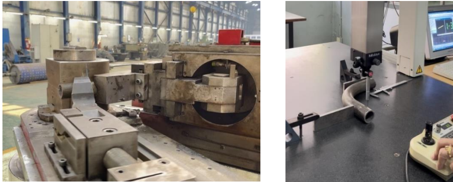
ภาพที่ 1 การตัดท่อด้วยเครื่องตัดแบบโรตารี และการวัดขนาดด้วยเครื่อง CMM
