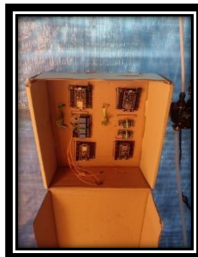
ภาพที่ 5 แสดงการติดตั้งอุปกรณ์ IoT ภายในโรงเพาะเห็ด
